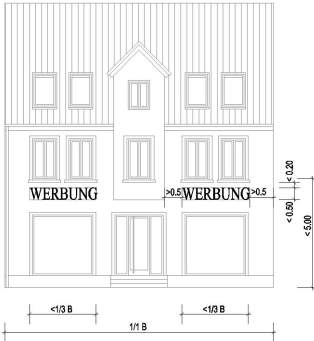
Abb.: Anbringung von Werbeanlagen parallel zur Fassade
